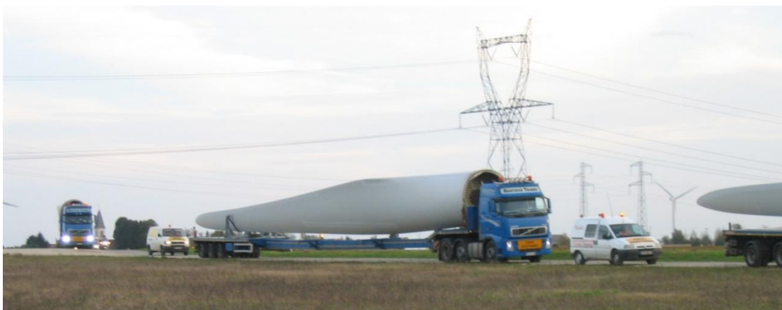
Figure 139 : Illustration du transport des pales (©ATER Environnement)
